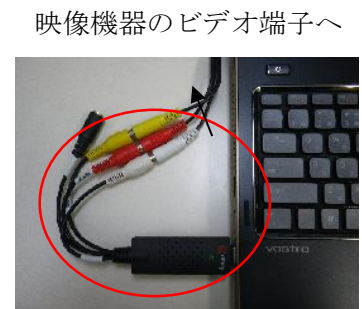
映像機器のビデオ端子へ PCに取付けたキャプチャー装置
